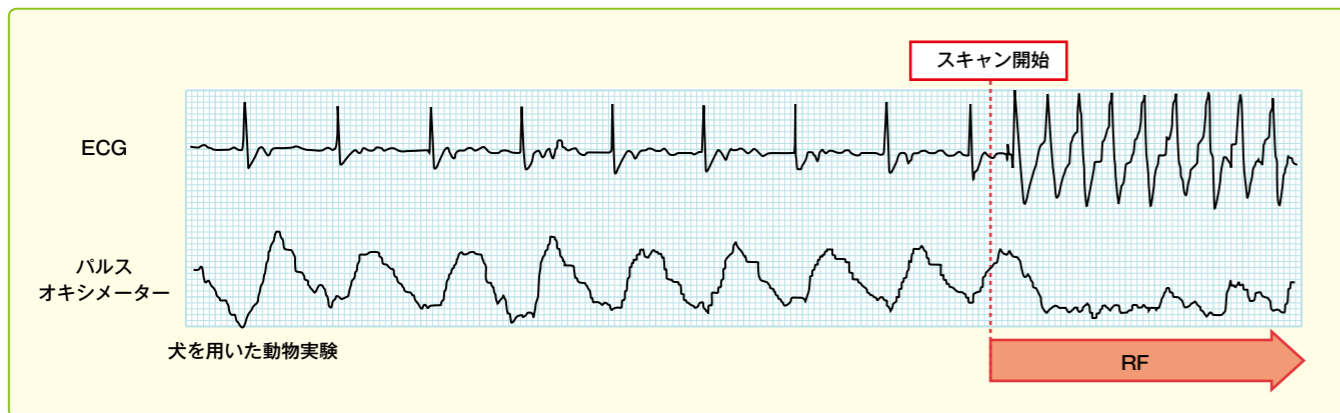
図1 UCS (Medtronic 社提供) これは動物実験中に記録された頻脈刺激である。スキャン開始でRF照射を行ったところ異常な刺激が発生した。頻脈周期約220 msで、ノイズトラッキングなどのペースメーカーの設定パラメータからは考えられない頻度の刺激である。これらの刺激は傾斜磁場やRFによって電極に異常電位が発生することによって生じると推測されている。
