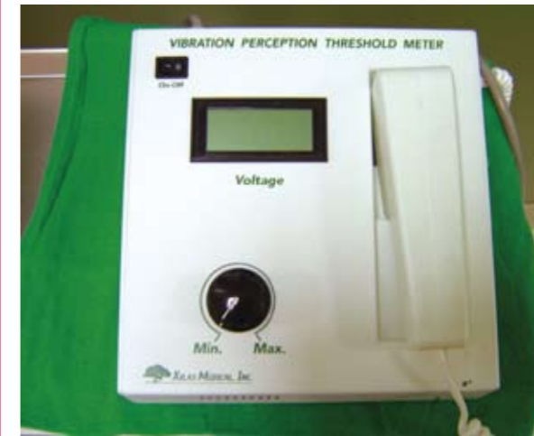
図1 VPT (Vibration Perception Threshold) メーター Xilas Medical 社製
